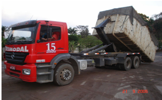
Foto 3: Sistema roll on/ roll off em operação
